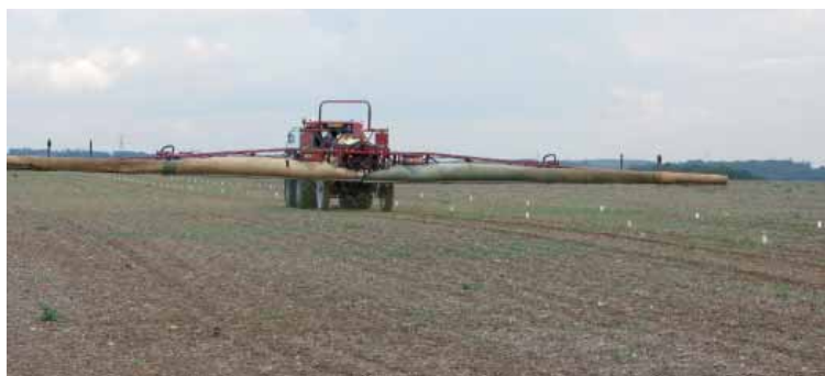
Figure 2 : Injection directe « active », système Raven. Système étudié sur : pulvérisateur Hardi Commander avec une rampe de 24 m.
