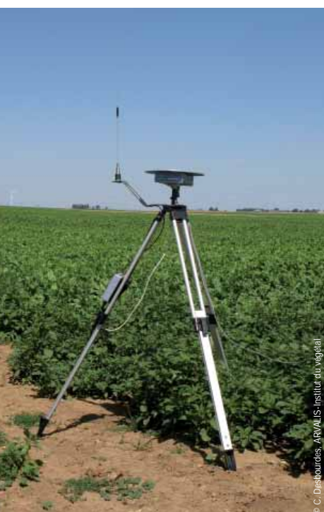
Base RTK mobile localisée en bout de champ.
