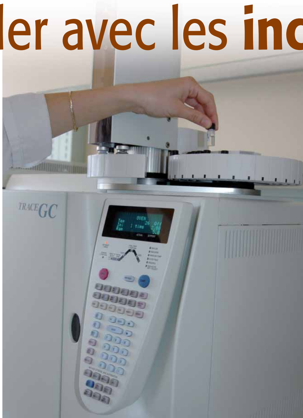
Le dosage par chromatographie, même s'il nécessite un mode opératoire complexe, est la référence pour le dosage des mycotoxines.
