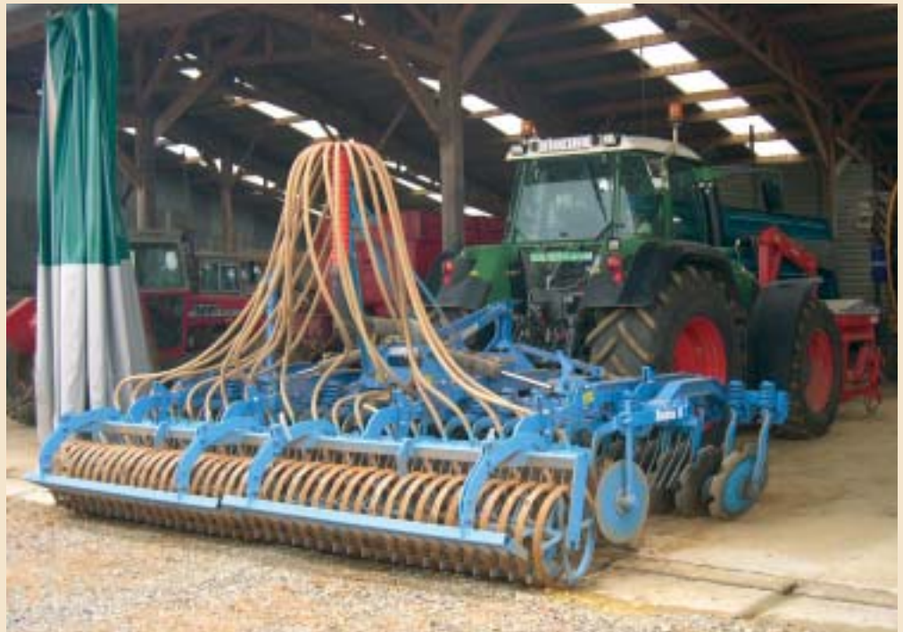
Les semences sont réparties entre 20 tuyaux qui débouchent à l'arrière de la 2 e rangée de disques.
