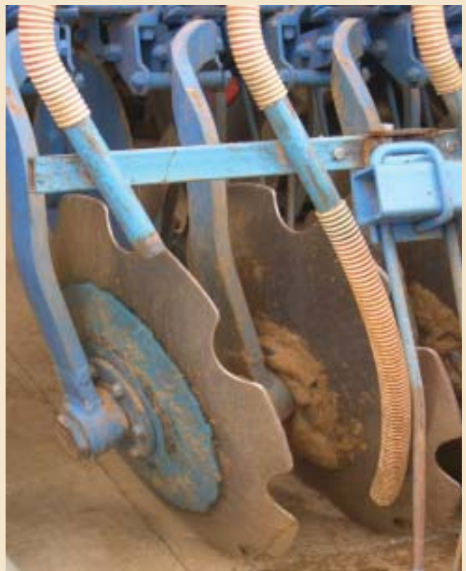
Un système de rallonge de tuyaux permet de moduler la profondeur de semis sans modifier la profondeur de travail.
