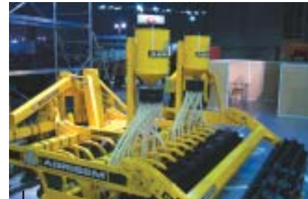
Les outils à disques indépendants se démarquent notamment des cover crop par leur bonne capacité d'émiettement de la couche travaillée.
