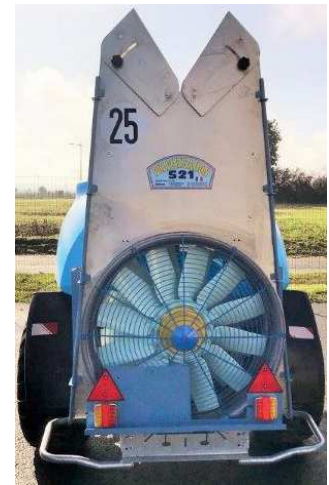
S21 – Double turbine vergers voûte droite
