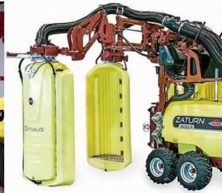
HARDI - panneaux récupérateurs OPTIMUS
