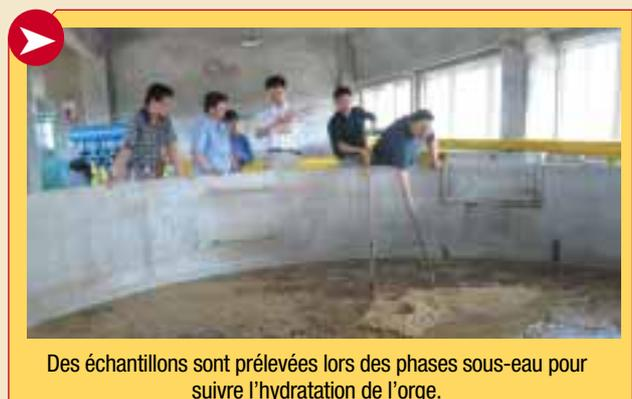
Des échantillons sont prélevés lors des phases sous-eau pour suivre l'hydratation de l'orge.
