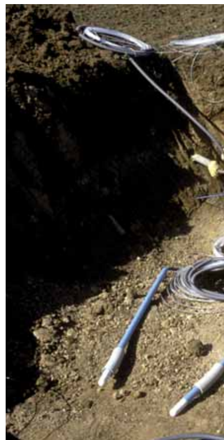
La pose de bougies poreuses permet de recueillir la solution du sol.
