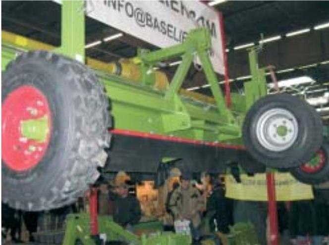
**Dispositif de replombage de buttes montée sur broyeur de fanes (Euro-Direct).**
