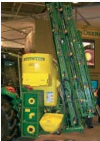
Nouvelle série 400 A (A pour rampe arrière) avec des cuves de 800, 1000 ou 1200 litres.
