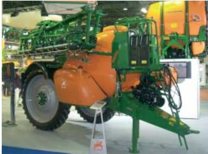
Visible sur le stand Amazone, le nouveau pulvérisateur trainé UX (4200 ou 5200 litres) est doté d'une cuve en polyéthylène de forme résolument nouvelle, permettant de limiter l'encombrement et les mouvements du liquide dans la cuve tout en abaissant le centre de gravité. Le poste de remplissage regroupe tous les éléments, bac incorporateur, filtres et la vanne "unique" Monovario.
