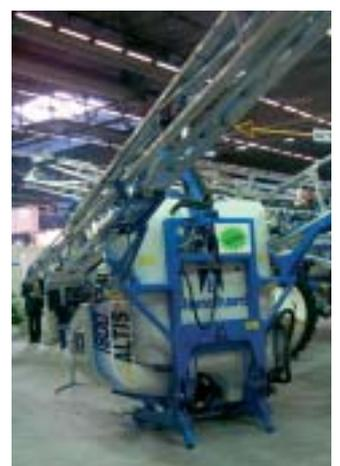
Nouveau venu sur le marché des pulvérisateurs portés de grosse capacité, l'Altis 1800 de Blanchard propose des rampes aluminium de 18 à 28 mètres. Le pulvérisateur trainés Grand Large est maintenant disponible en 5000 l avec une rampe aluminium de 36 mètres et reçoit un dispositif de vannes multifonctions.
