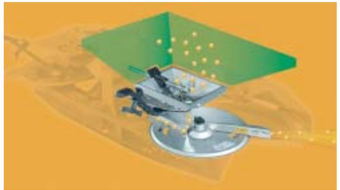
L'appellation SBS chez Amazone reprend les caractéristiques fondamentales de ces distributeurs d'engrais ; agitateur lent, point de chute proche du centre des disques, système dit "anti poussière" (vitesse de rotation faible des disques : 720 tr/mm), aubes longues. Le boîtier Amatron + est commun aux appareils de la marque et les largeurs de remplissage des trémies importantes, jusqu'à 2,75 mètres.
