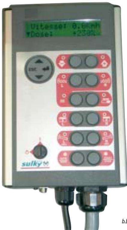
La console de pilotage Axion a reçu une médaille d'argent, et concerne les épandeurs traînés de pulvérisants à disques et rampes à vis. Elle permet d'ajuster la qualité du travail en fonction de l'observation visuelle du chauffeur. En effet, avec une rampe à vis, le travail est délicat (répartition, dévers, manœuvres). Le boîtier Axion mémorise des séquences, degré d'ouverture des vannes en fonction de la vitesse d'avancement, repliage des rampes...
