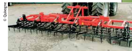
▲ La herse lourde est un outil assez simple qui, par sa conception en compartiments, a la capacité de s'adapter à la topographie du terrain.
