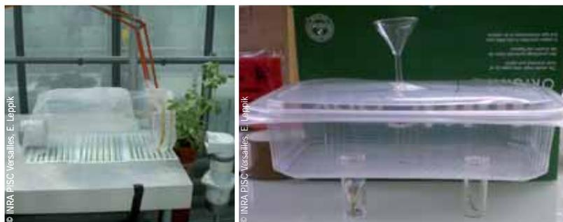
Pour évaluer l'attractivité d'une odeur, des insectes sont placés dans des dispositifs où ils peuvent choisir de se déplacer ou non vers une odeur naturelle ou de synthèse (tunnel de vol à droite, pitt-fall à gauche).
