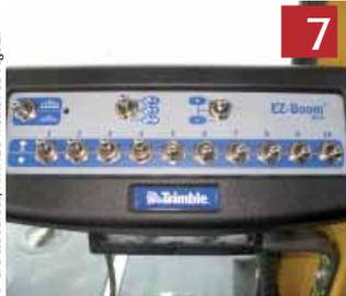
▲ Le système de coupure de tronçons peut être intégré dans la barre de guidage.
