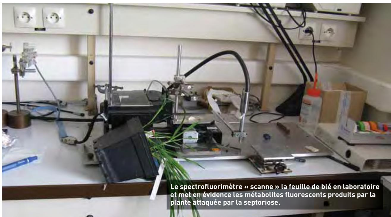
Le spectrofluorimètre « scanne » la feuille de blé en laboratoire et met en évidence les métabolites fluorescents produits par la plante attaquée par la septoriose.
