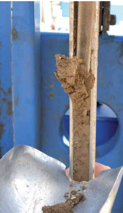
Des échantillons de sol sont prélevés par carottage.
