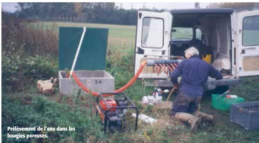
Prélèvement de l'eau dans les bougies poreuses.
