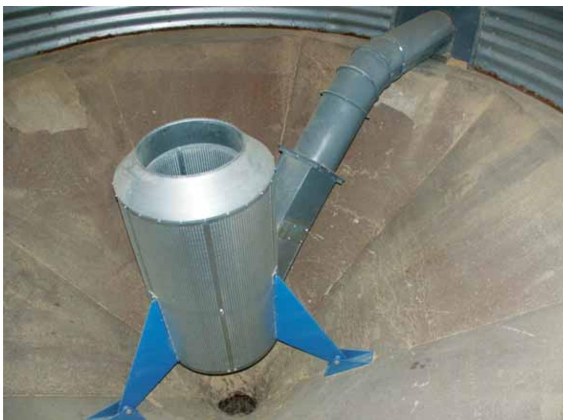
**S**e posant directement sur le sol existant, sans adaptation particulière, le diffuseur Rocket™ d'Agri-Consult est constitué d'un manchon métallique dont les doubles parois circulaires concentriques sont perforées sur toute leur hauteur. Fermée uniquement dans sa partie supérieure, la couronne ainsi formée constitue un espace vide qui doit être relié au ventilateur par une gaine d'arrivée d'air, non fournie. Le grain se répartit à la fois
