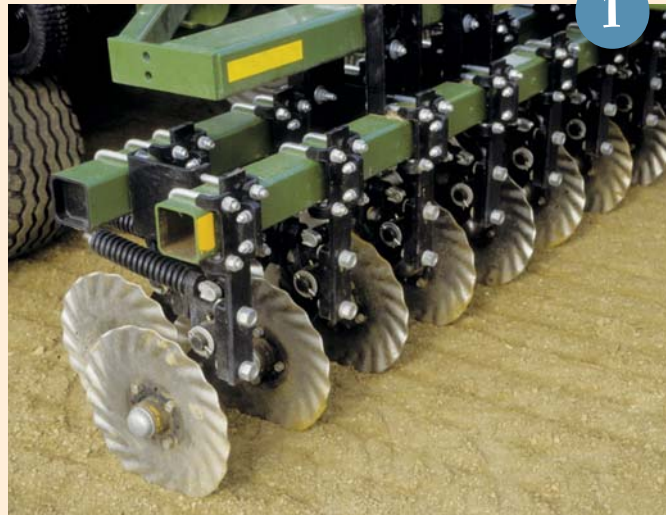
Module des disques ouvreurs du Great Plains ("Turbodisques") : la forme particulière des ondulations permet de mieux dégager les résidus végétaux de la ligne de semis.
