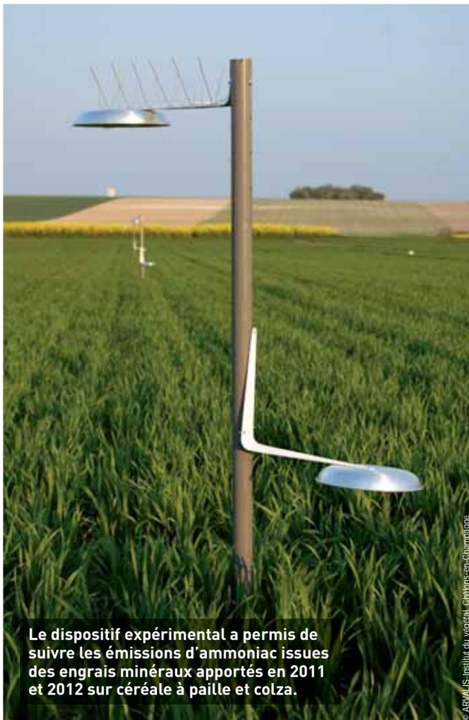
Le dispositif expérimental a permis de suivre les émissions d'ammoniac issues des engrais minéraux apportés en 2011 et 2012 sur céréale à paille et colza.
