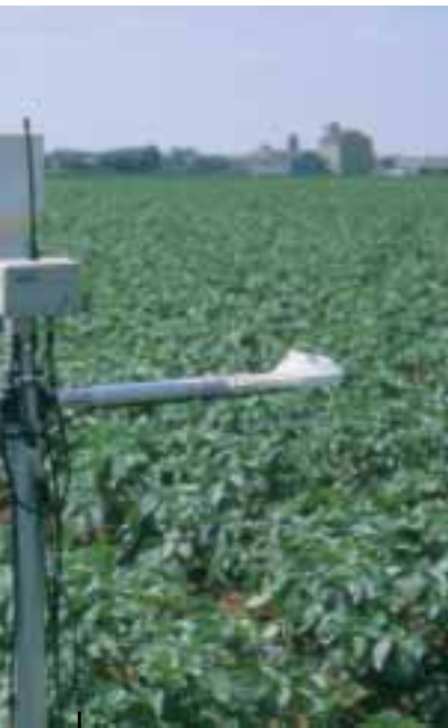
Une station météorologique réduite, composée de capteurs d'hygrométrie, de température et de pluviométrie, située à proximité de la parcelle, est nécessaire pour utiliser Prémil.
