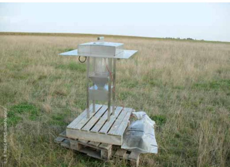
**Le piège lumineux n'est pas spécifique: les papillons capturés doivent être identifiés avant d'être dénombrés.**
