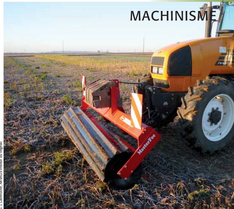
▲ Des rouleaux pleins conçus pour écraser les couverts sont aujourd'hui fabriqués en France, en s'inspirant des « rolo faca » brésiliens.
