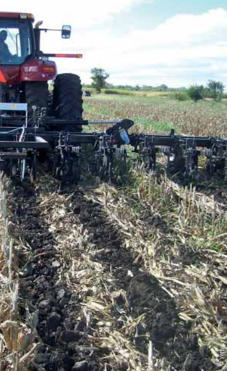
Le strip till revient à travailler la parcelle sur des bandes de 10 à 20 cm de large et sur une profondeur allant de 5 cm jusqu'à 25-30 cm de profondeur.
