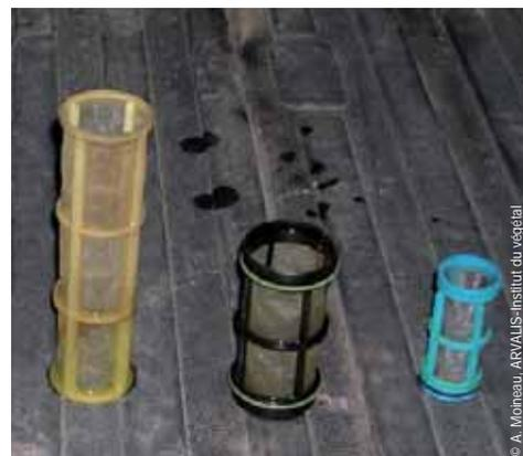
**Pour être efficace, la filtration doit être progressive sur le circuit, de plus en plus fine en allant du remplissage vers la rampe.**
