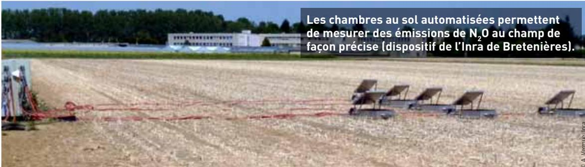
Les chambres au sol automatisées permettent de mesurer des émissions de  $N_2O$  au champ de façon précise (dispositif de l'Inra de Bretenières).
