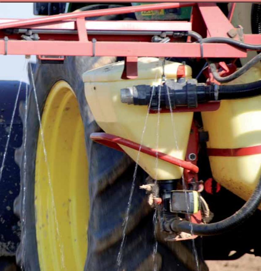
Pour éviter une trop forte pénétration de l'engrais par voie foliaire, et donc prévenir les brûlures, mieux vaut limiter au maximum la couverture du feuillage et s'orienter vers des buses de type filet.
