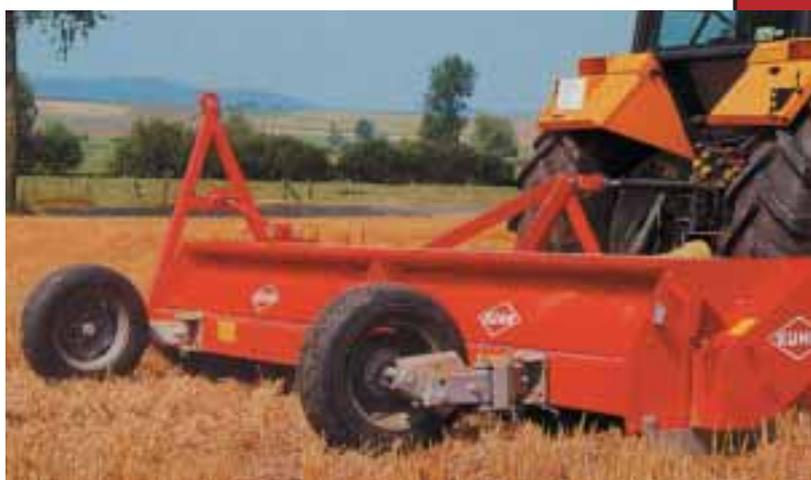
Broyeur à axe horizontal
