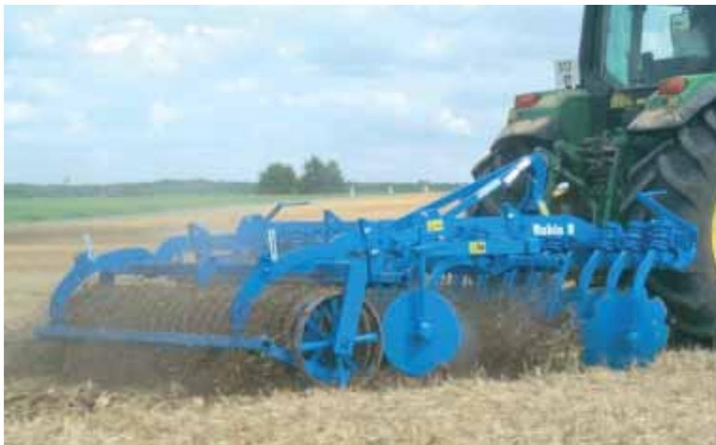
**L**e Rubín de Lemken est proposé en 6 largeurs : en châssis fixe de 2,5 à 4 m (versions portées) et repliable de 4 à 6 m (versions portées ou semi-portées). Equipé de disques de grand diamètre (610 mm), il s'adapte bien à tous types de déchaumage, du plus superficiel au plus profond, tout en bénéficiant d'une bonne tenue à l'usure.
