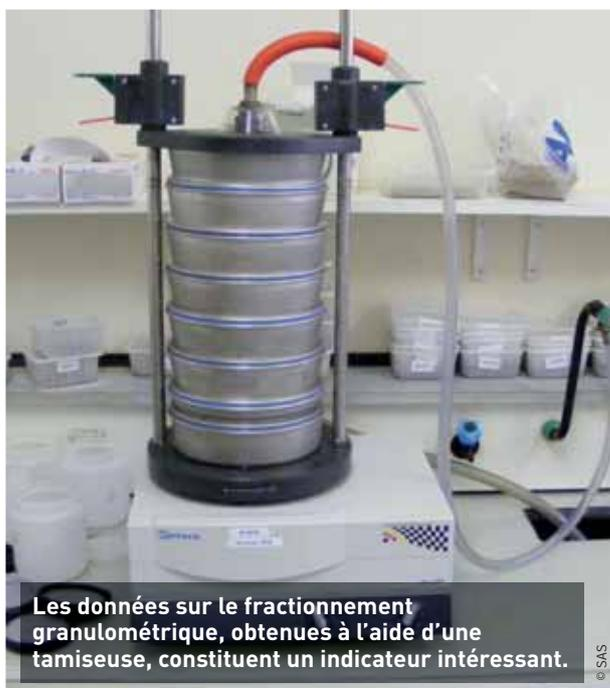
Les données sur le fractionnement granulométrique, obtenues à l'aide d'une tamiseuse, constituent un indicateur intéressant.
