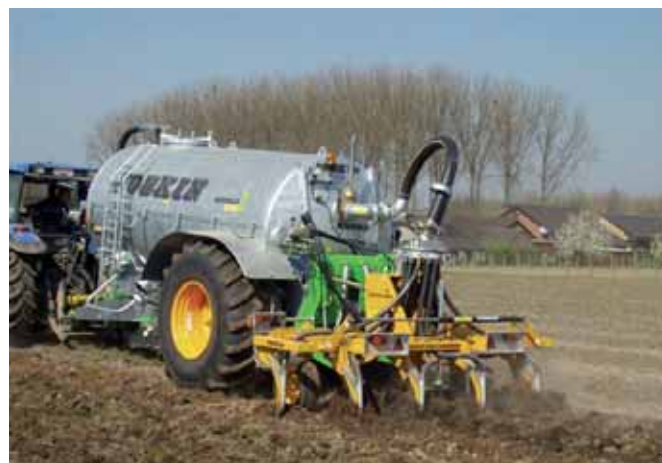
L'utilisation d'une tonne à lisier avec injecteurs permet de limiter la volatilisation de l'azote ammoniacal contenu dans les lisiers. © Joskin
