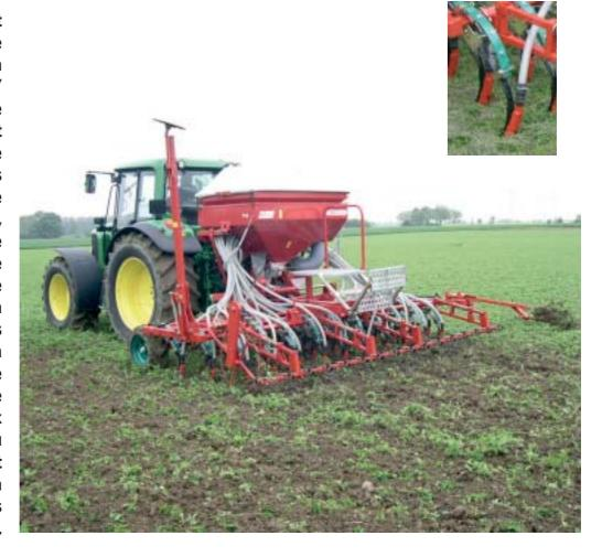
deux parties indépendantes repliables hydrauliquement depuis la cabine. Une fois replié, la largeur de transport n'excède pas 3 m. Les dents de semis, équipées du système de sécurité non-stop à lames bien connu chez Kverneland, s'escamotent de manière progressive face à l'obstacle. La profondeur de semis est bien contrôlée grâce à des
