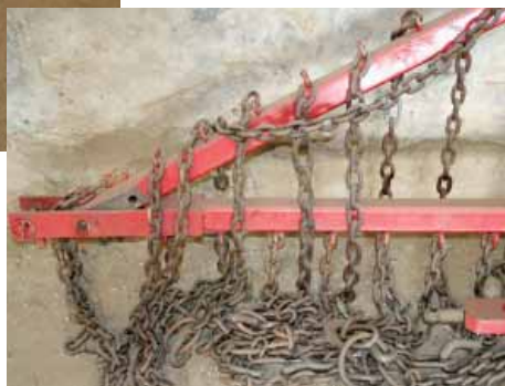
Les barres d'envol installées à l'avant d'un tracteur permettent d'effaroucher le gibier et de limiter les destructions.
