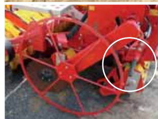
La roue d'entraînement de la distribution est automatiquement freinée lorsqu'on relève la machine.
