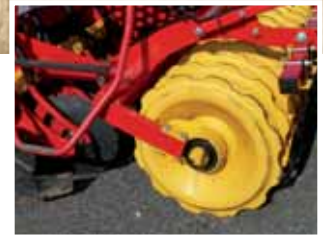
Le rouleau du Carrier Drill réalise un rappui sélectif de qualité.
