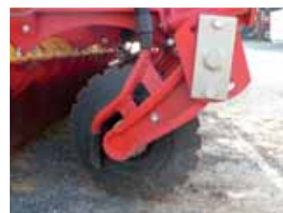
La semence est déposée dans l'ombre du disque de déchaumage.
