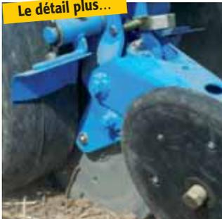
Mise en service, ou hors service, pratique et rapide de la roue de rappuyage.
