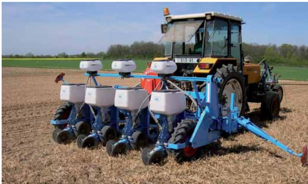
**L**es Monosem NX se déclinent en 5 modèles de 4 à 16 rangs. Les 4, 6 et 8 rangs sont proposés en châssis porté ou traîné et les modèles grande largeur de 12 et 16 rangs en châssis traîné. La pièce maîtresse de leur châssis est constituée d'une poutre carrée en acier de 180 x 180 mm conférant à l'ensemble une grande rigidité et un poids important. Cette
