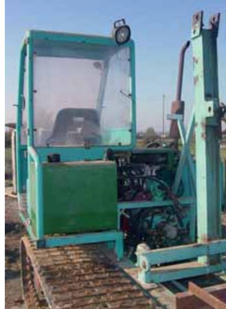
Alors que la machine disposait d'un moteur atmosphérique Iveco de 85 CV, Hubert Massardier a fait le choix d'augmenter la puissance et de passer à un moteur turbo de 110 CV.
