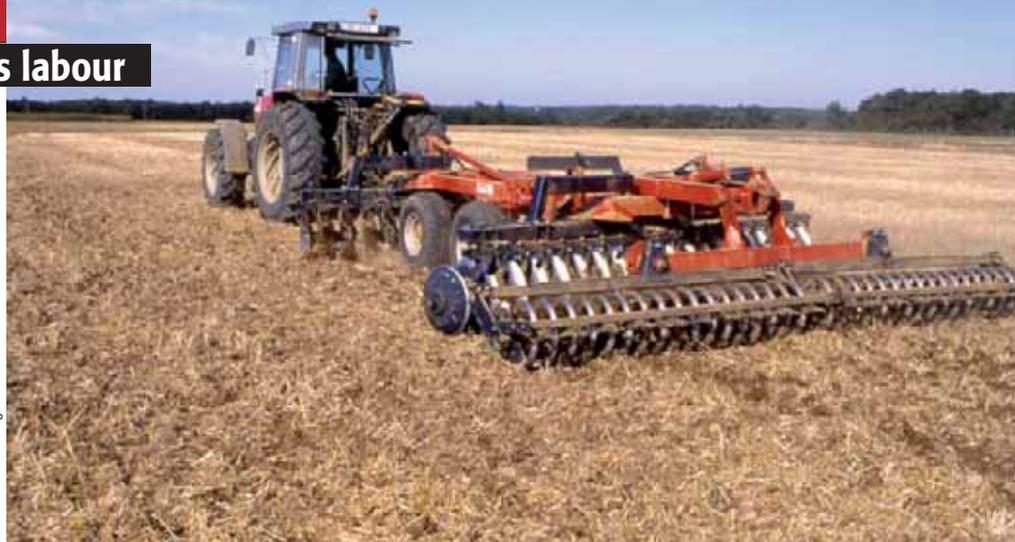
**En non labour, le déchaumage permet d'adapter les conditions de sol au semoir et aux besoins de l'espèce à implanter.**
