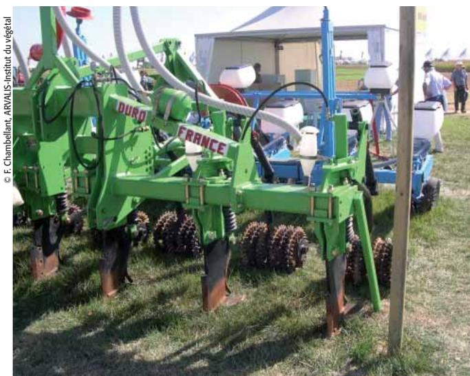
**La technique du « strip till » permet de travailler le sol en profondeur spécifiquement devant chaque élément semeur.**
