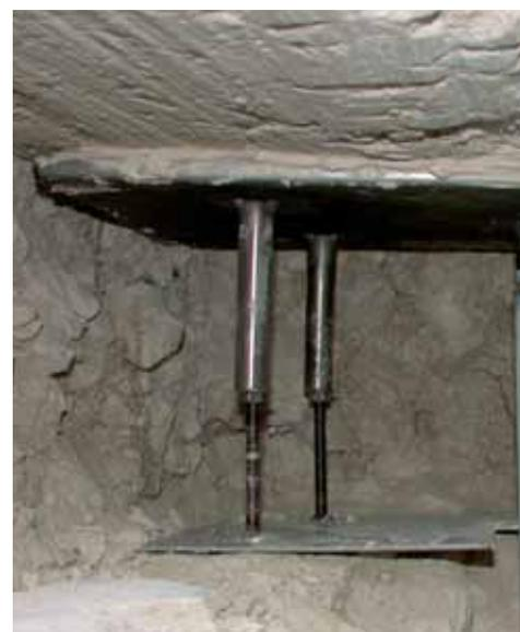
Une plaque, placée à la profondeur souhaitée, collecte les eaux d'infiltration. Une mèche de fibre de verre, aux propriétés conductrices, attire l'eau, que le sol soit saturé ou non. Celle-ci est évacuée par un réseau de canalisations jusqu'à un bidon de stockage.
