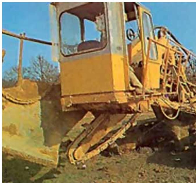
Les deux tiers des réseaux de drainage sont réalisés avec un coudre.
