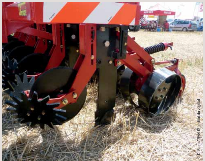
L'outil proposé par Jammé présente une dent fine et droite qui fissure avec un faible bouleversement de surface.
