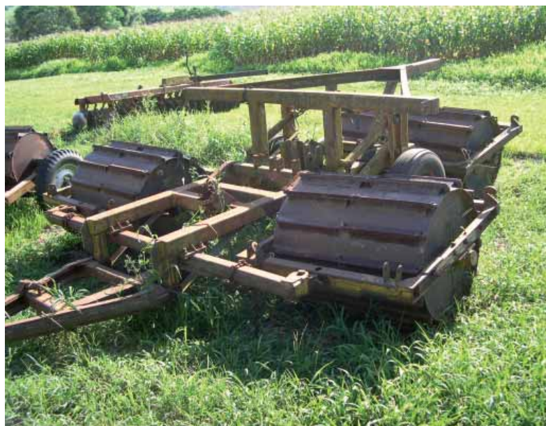
Les modes d'actions des rolo-faca permettent de broyer ou d'écraser les plantes même sans gel.
