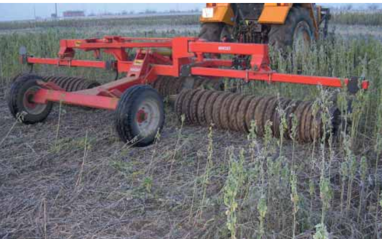
Un roulage avec un outil de type Cambridge affiche un débit de chantier de 3 ha/h.
