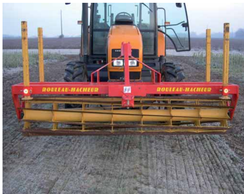
Le rouleau Drax s'est montré efficace même sans gel, mais ne fonctionne correctement que si un certain nombre de conditions sont réunies.
