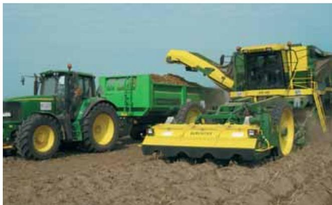
La nouvelle automotrice 4 rangs combinée Ploeger AR-4B est équipée de palettes de contrôle de la profondeur - en substitution aux traditionnels diabolos - et de disques entraînés hydrauliquement. Des chenilles arrière, de 900 mm de large, assurent la traction de la machine. L'automotrice dispose d'un nettoyage par rouleaux axiaux à écartement ajustable déversant la récolte dans un élévateur arrière longitudinal à paniers souples.
