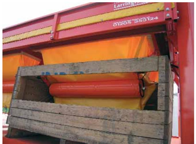
Richard Larrington Ltd propose un dispositif breveté d'entonnoir matelassé de remplissage de palox équipé de coussins amovibles de fermeture permettant de réduire au mieux le risque d'endommagement des tubercules par une dépose délicate en fond de caisse.
