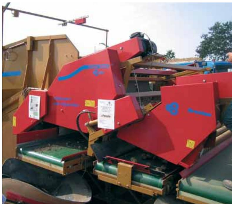
Deux nouveaux matériels de tri qualitatif en ligne pour les centres de conditionnement : le modèle Ellips de la société Hortagro Int. et la nouvelle génération Optiscan II de Maf Roda. Tous deux alignent les tubercules en rangées individuelles, puis les examinent à l'aide de caméras vidéo pour y déceler les défauts de qualité à un rythme de 6 à 10 tubercules par seconde par ligne de tri. Ils sont ensuite délicatement éjectés sur la sortie appropriée.
