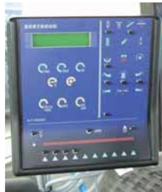
**Hardi** propose sur son Commander I, un système de gestion automatique des coupures de tronçon, Auto-SectionControl, basé sur le positionnement GPS. Les tronçons sont coupés automatiquement pour éviter les recouvrements de rampes : fini les surdosages dans les parcelles. ■
