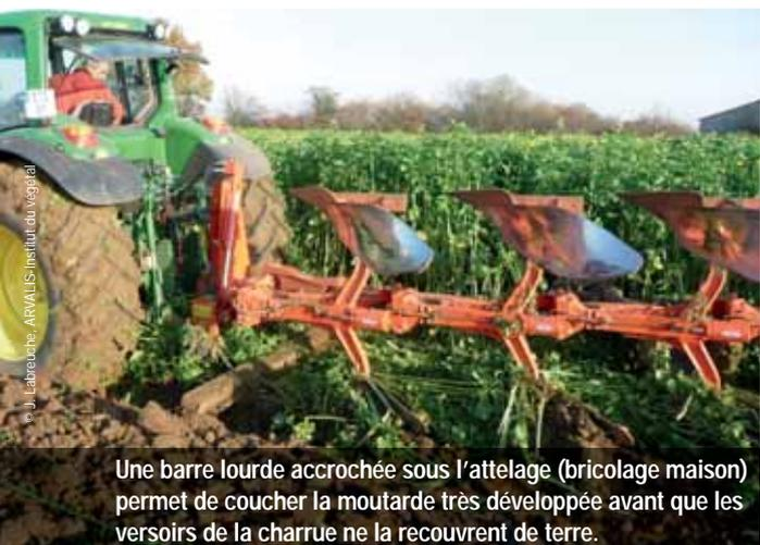
Une barre lourde accrochée sous l'attelage (bricolage maison) permet de coucher la moutarde très développée avant que les versoirs de la charrue ne la recouvrent de terre.
