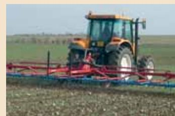
**2. Réservee aux cultures en ligne à grand écartement, la bineuse mécanique**, à dents ou à étoiles, consiste à travailler le sol de manière superficielle, afin de détruire les mauvaises herbes. A dents ou à étoiles, les bineuses travaillent l'inter-rang de la culture. L'utilisation d'un outil autoguidé, à la manière de ceux utilisés en betterave, permet d'accroître les vitesses de désherbage.
