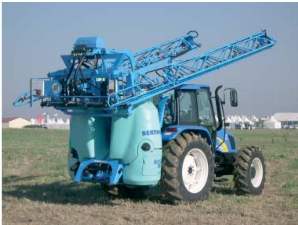
**A**vec un design compact et arrondi, le pulvérisateur porté Elyte ne passe pas inaperçu. Aucun équipement ne dépasse et le poste de remplissage et de gestion des vannes est rassemblé derrière un capot faisant également fonction de cuve lave-mains.
