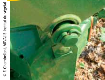
© F. Chambelland, ARVALIS-Institut du végétal Certaines articulations des éléments semeurs sont montées sans bague.
