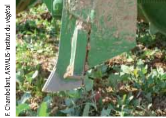
© F. Chambelland, ARVALIS-Institut du végétal Les socs, fixés par un boulon, sont facilement interchangeables.
