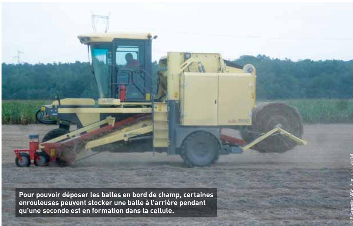
Pour pouvoir déposer les balles en bord de champ, certaines enrouleuses peuvent stocker une balle à l'arrière pendant qu'une seconde est en formation dans la cellule.
