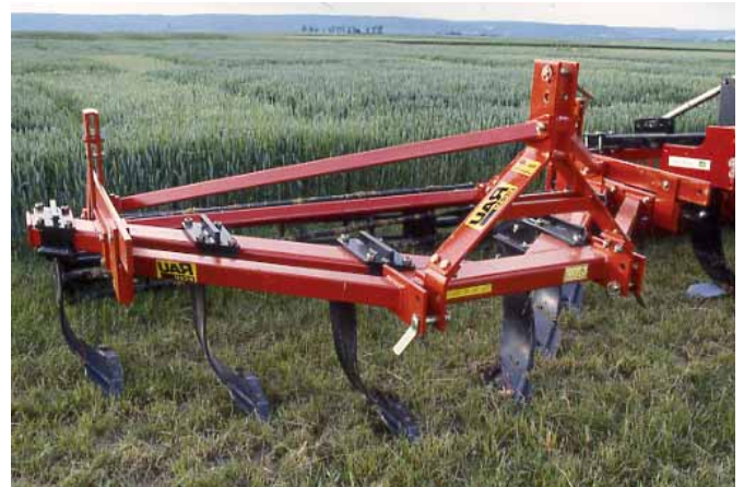
Le châssis en V devient nécessaire quand le nombre de dents par mètre augmente.
