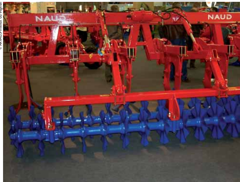
Les rouleaux à doubles disques ondulés complètent le travail de l'outil en agissant sur l'horizon superficiel.
