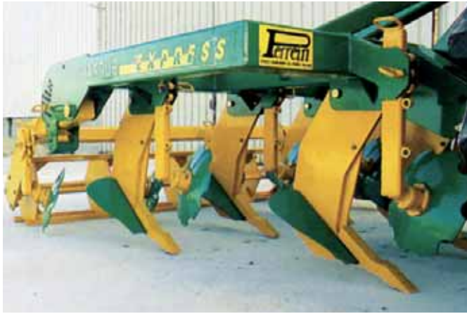
La charrue Express de Perrein permet de répartir de façon homogène les débris végétaux sur l'horizon travaillé.
