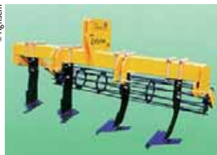
La dent Agrisem est utilisée avec un écartement de 70 à 75 cm.
