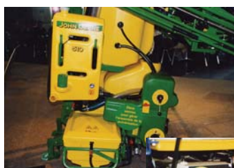
Grande capacité de l'incorporateur, réduction du nombre de leviers. John Deere propose, sur ses modèles portés, un poste de remplissage ergonomique.
