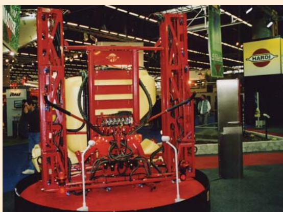
Repliage compact de la rampe Pro respectant le gabarit routier (2,50 m).
