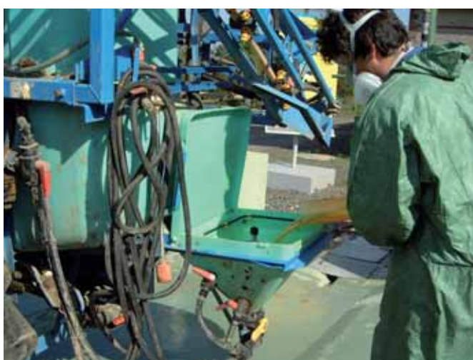
Les bacs d'incorporation des derniers pulvérisateurs permettent d'incorporer les produits en étant au sol en position stable, augmentant la sécurité des opérations.
