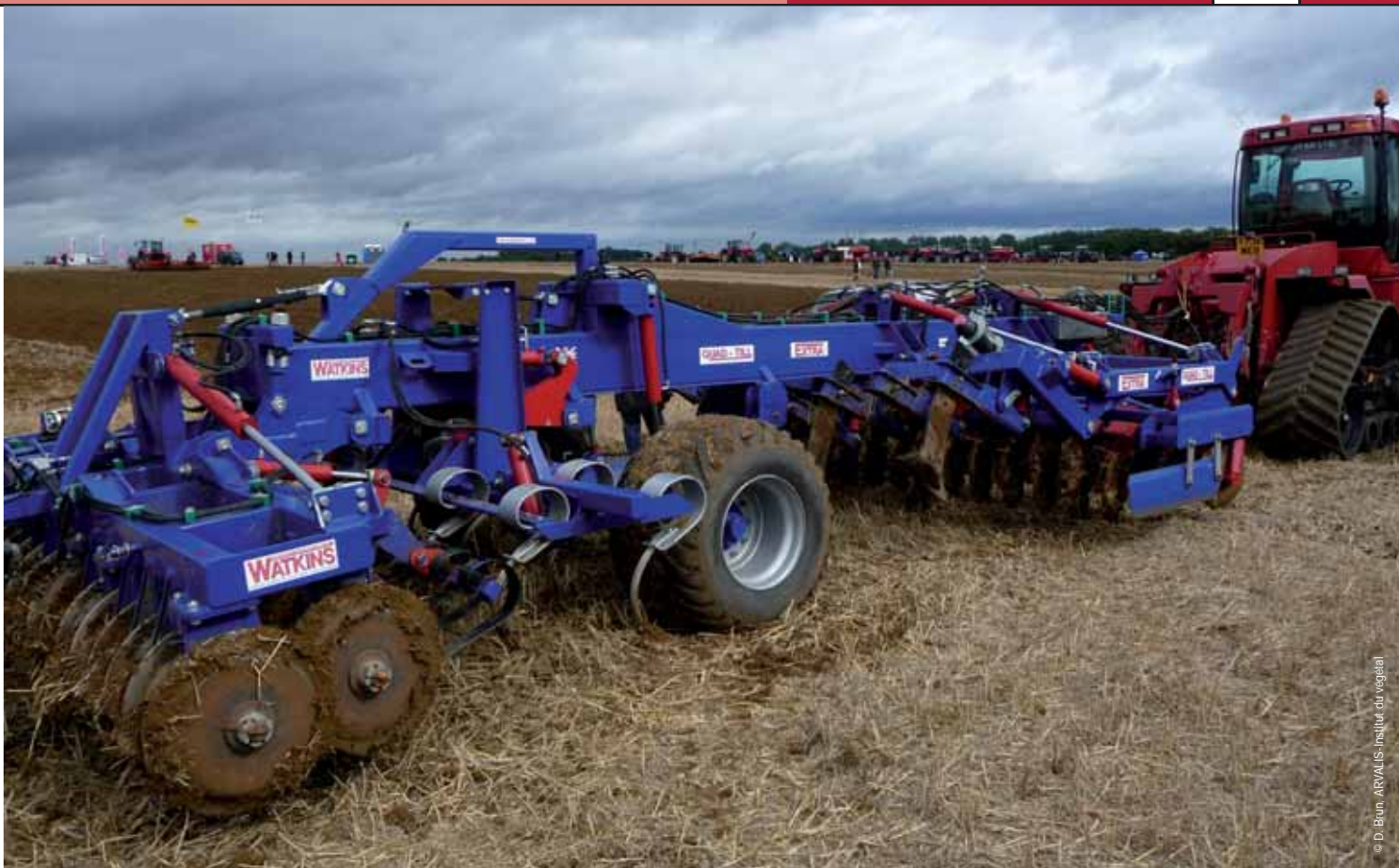
Spécifique au marché anglais, le Quad-Till nécessite 80 à 100 ch/m.
