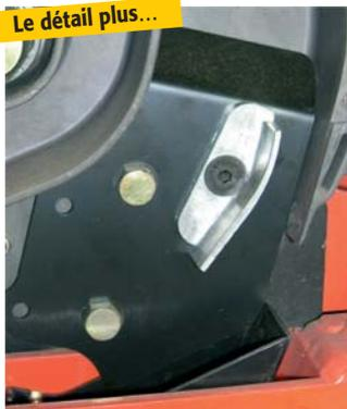
Le système de distribution bénéficie d'un guide en fin de dépression plaqué contre le disque dont le rôle est d'accompagner la chute de la graine dès sa sortie du disque afin d'améliorer la régularité de semis sur le rang.
